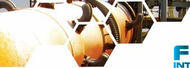
Sistemas de bateção são implementados para contrapor a aderência dentro do secador rotativo. Escolher o sistema de bateção correto para o seu material irá auxiliar a obter a eficiência máxima do secador. A FEECO fabrica três tipos diferentes de sistemas de bateção, todos eles acoplados na entrada do secador rotativo, onde o material sendo alimentado está mais úmido e grudento.
